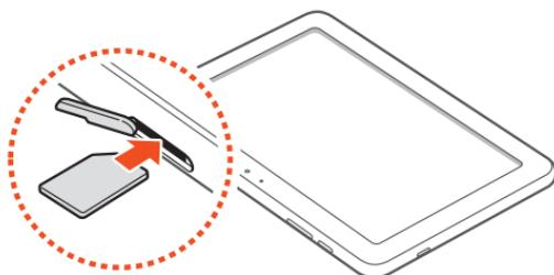
**!** Der SIM-Kartensteckplatz Ihres Geräts ist nur für standardmäßige SIM-Karten geeignet. Durch Einsetzen einer microSIM-Karte oder einer microSIM-Karte mit nicht autorisiertem Inhaber kann der SIM-Kartensteckplatz des Geräts beschädigt werden.
